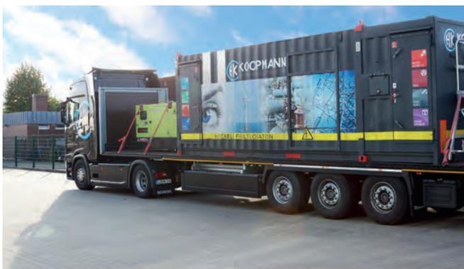
On- und Offshore Fehlerortungssystem für Kabelsysteme bis 525 kV
